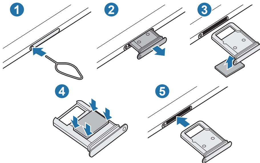
1 Insérez l'outil de retrait à l'endroit prévu à cet effet sur le compartiment pour le déverrouiller.
